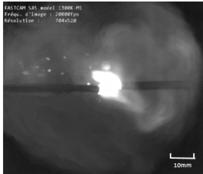
FIGURE 3.4 – Image de l'émission de la raie H_\alpha par un plasma d'eau créé par arc observée avec un filtre passe-bande, anode à gauche et cathode à droite
