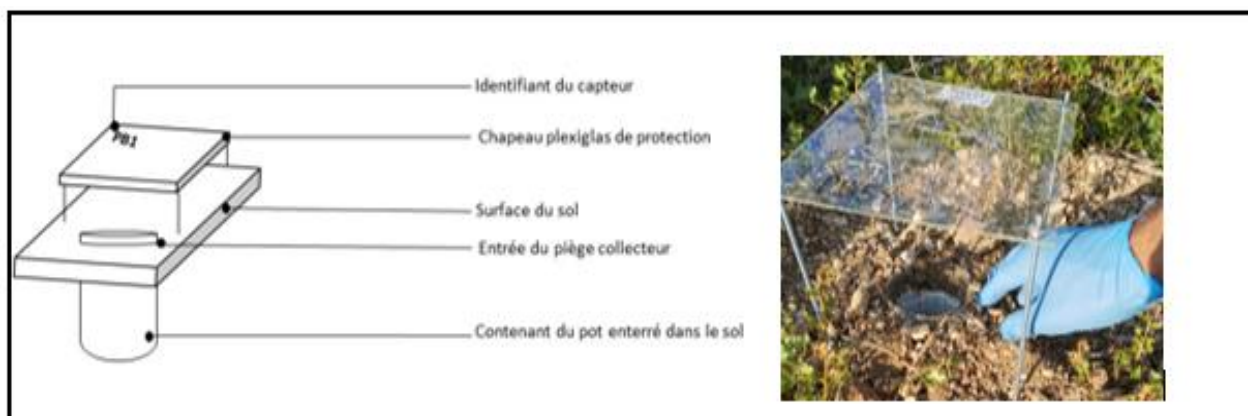
Figure 36. — Capteur « pot de Barber » (PB) utilisé pour échantillonner les macro-arthropodes terrestres au sol dans les garrigues (N. Froustey, IMPCF).
