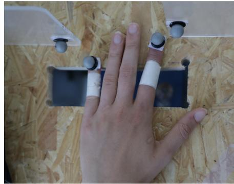
FIGURE 5.11 – Marqueurs de capture de mouvement placés au bout des doigts et sur les repères.
