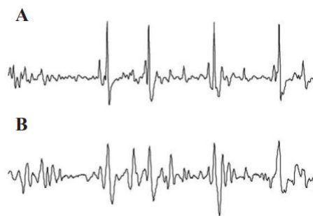
FIGURE 3.6 – Différence de signal EMG entre les électrodes à aiguille et les électrodes de surface. A) Signal EMG à aiguille. B) Signal EMG détecté par une électrode de surface. Muscle : L'abductor pollicis brevis [8].
