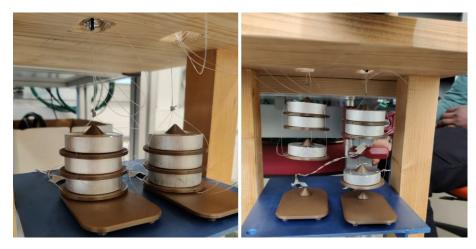
FIGURE 5.12 – Le système de masses permettant un empilement simplifié avec un capteur de compression sous la plaque de base.
