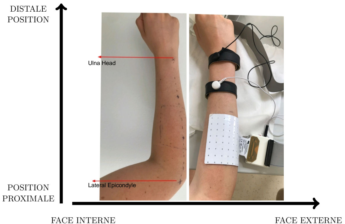
FIGURE 5.8 – Configuration pour l’acquisition d’enregistrements HDsEMG. Positionnement de la matrice d’électrodes et des électrodes de référence à droite de l’avant-bras du sujet (Fig. de droite). Représentation des repères anatomiques utilisés pour positionner la matrice (Fig. de gauche).
