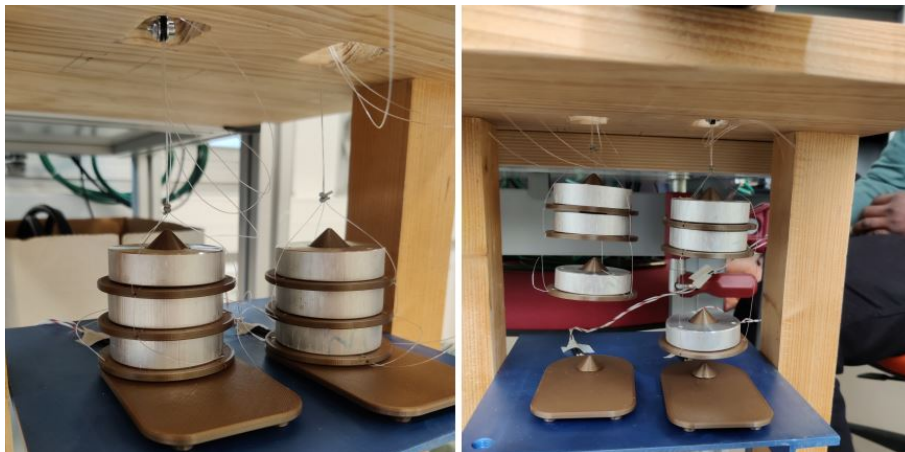
FIGURE 5.12 – Le système de masses permettant un empilement simplifié avec un capteur de compression sous la plaque de base.
