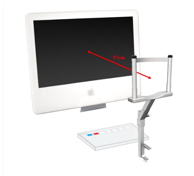
Figure 12 : Appareillage de l'expérience 1 comportant écran, reposeur, et pavé de réponse. Deux touches sont ici surlignées en couleur pour plus de visibilité, mais lors de l'expérience un autocollant "joie" et un "colère" étaient posés sur ces deux touches.
