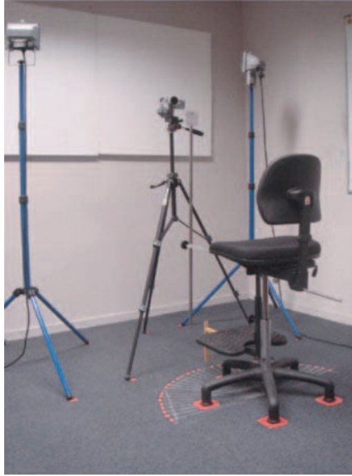
Figure 10 : Dispositif d'enregistrement des vidéos comportant caméra, éclairage indirect et fauteuil tournant. Source : Arnold (2011).
