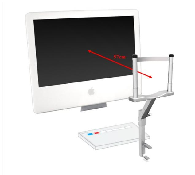
*Figure 12 : Appareillage de l'expérience 1 comportant écran, reposeir, et pavé de réponse. Deux touches sont ici surlignées en couleur pour plus de visibilité, mais lors de l'expérience un autocollant "joie" et un "colère" étaient posés sur ces deux touches.*
