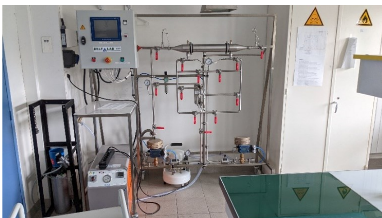
Figure 81: Banc d'étude composé de deux échangeurs thermiques.
