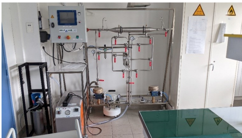
Figure 81: Banc d'étude composé de deux échangeurs thermiques.
