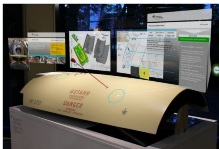
Figure 16: Exemple d'une inspection collaborative du point de vue de l'opérateur local. L'avatar de l'Expert est représenté par la boîte rouge et son regard par le trait rouge. Le cercle bleu représente un dommage identifié. Extrait de (Utzig et al., 2019).
