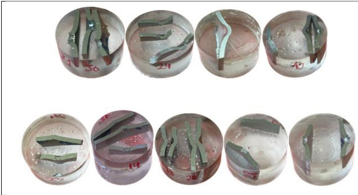
**Figure 91: Panel de sections de la zone d'impact des éprouvettes additives et soustractives. 23 sections sont représentées sur cette photographie.**
