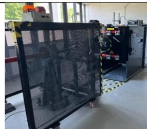
Figure 76 : Tunnel amovible anti-éclat et anti-blast
