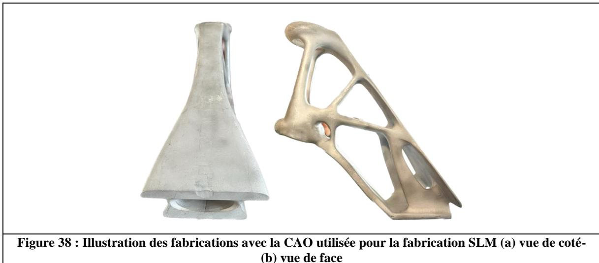
La fabrication du composant additif a été réalisée sur une imprimante SLM Realizer 250 suivant la CAO, le matériau mis en œuvre est l'alliage AlSi10Mg se présentant sous forme de poudre. L'épaisseur des couches de poudre est de 25  $\mu\text{m}$ , la vitesse de balayage du laser est paramétrée à 1,2  $\text{m}\cdot\text{s}^{-1}$  pour une puissance du laser de 400 W.
