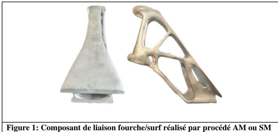
**Figure 1: Composant de liaison fourche/surf réalisé par procédé AM ou SM**
