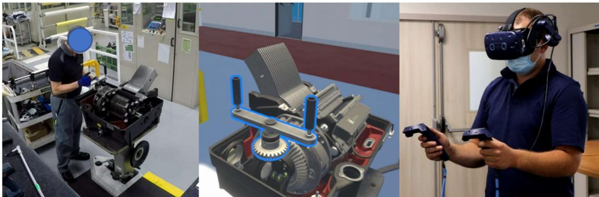
Figure 16 Poste de travail à gauche, Prototype VR au milieu et formé en VR à droite
