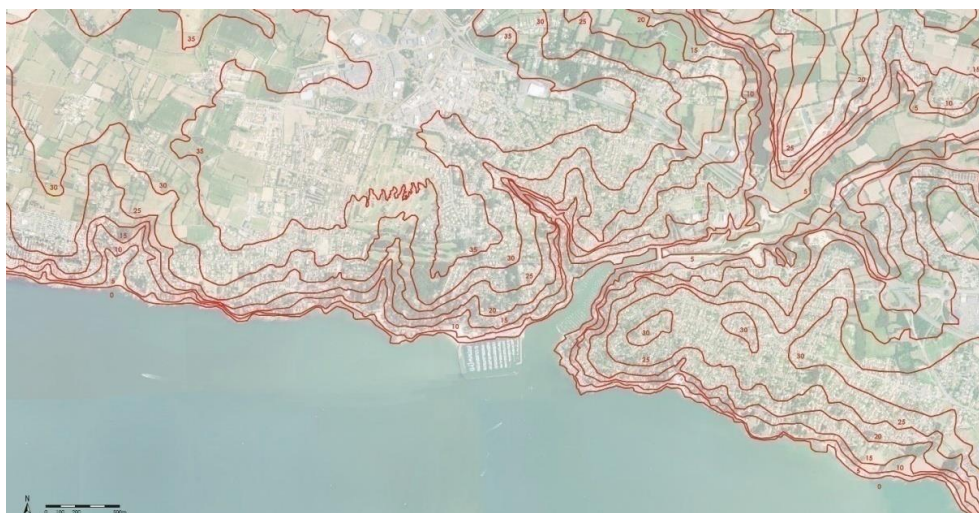
Fig. 96 : Carte CAUE - 44, chapitre les composants du paysage, le relief, l'hydrographie et la géologie, la concentration des courbes de niveaux montre bien le caractère accidenté en bordure de littoral propice au ruissellement, 2022.
