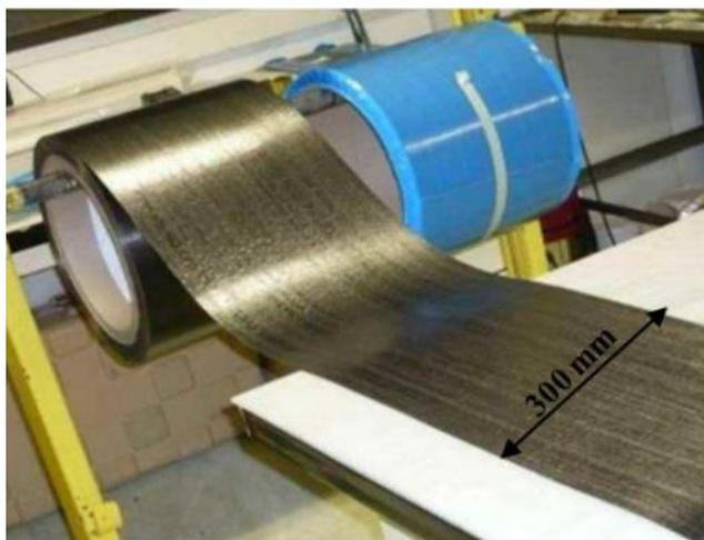
Figure 51 Un rouleau de préimprégné unidirectionnel T700/M21 carbone/époxy
