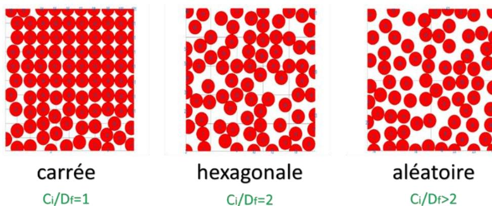
Figure 157 Trois configurations de la répartition des fibres avec différents rapports  $C_i/D_f$
