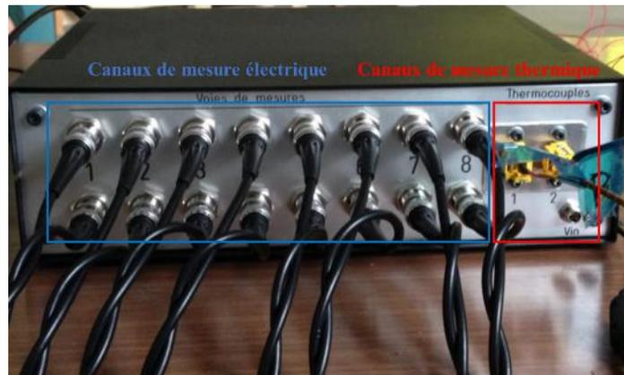
Figure 69 Les canaux des mesures du banc
