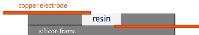
Figure 102 Schéma d'un échantillon de la résine non-renforcée dans un cadre en silicone
