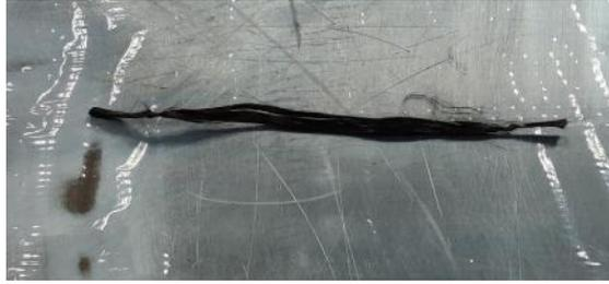
Figure 178 Mèche de fibre de carbone 80K Fortafil 51 de 150mm de longueur
