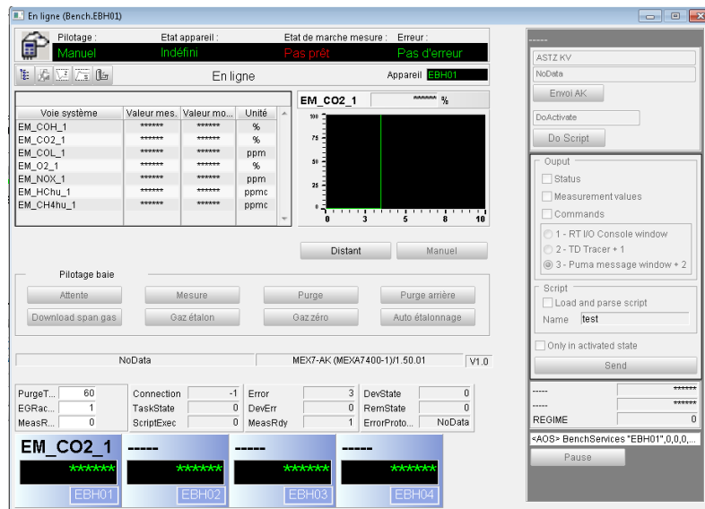
Figure 112. Interface de gestion de la communication et le contrôle de la baie d'analyse de gaz HORIBA sous PUMA
