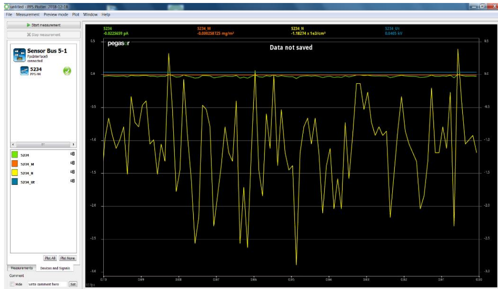
Figure 119. Interface de visualisation et d'enregistrement des mesures de particules sous PPS-Plotter
