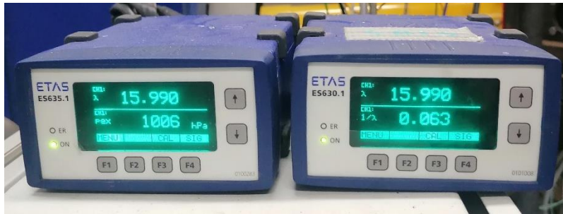
Figure 108. Photo des deux boîtiers ETAS ES635.1 et ES630.1 permettant la conversion des signaux lambda provenant des deux sondes placées en sortie turbine et en entrée échappement et dédiée à la mesure du banc.
