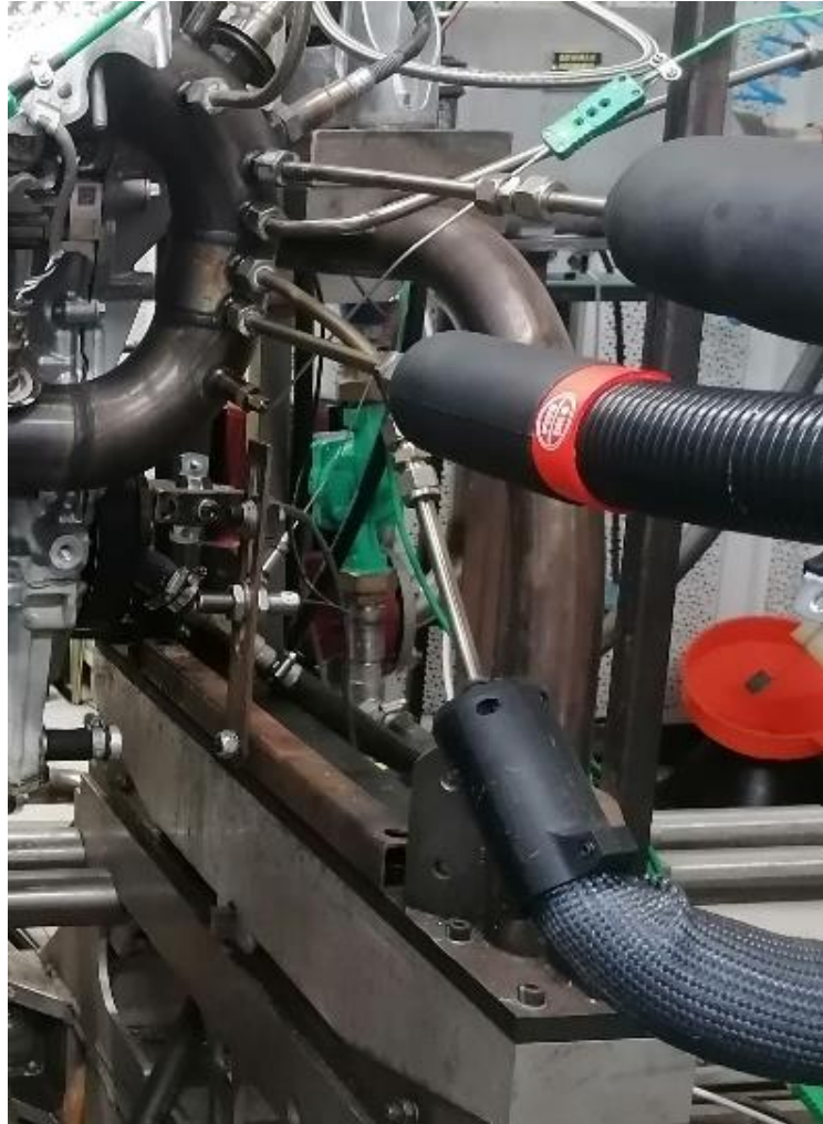
Figure 47. Endroits de prélèvements et de refoulement des gaz d'échappement pour PEGASOR et baie d'analyse de gaz HORIBA
