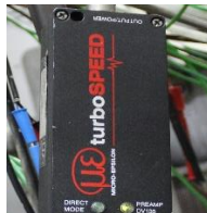
Figure 61. Photo du contrôleur DZ-135 du capteur de régime micro-epsilon
