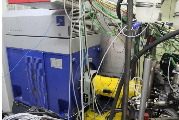
Figure 34. Machine de charge connectée via un arbre mécanique au moteur sujet d'essais.
