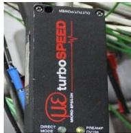
Figure 61. Photo du contrôleur DZ-135 du capteur de régime micro-epsilon
