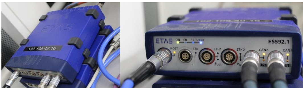
Figure 117. Photo du boîtier de communication entre INCA et l’ECU : ETAS ES592.1
