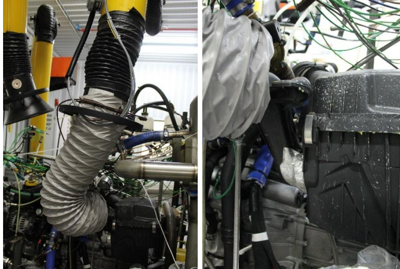
Figure 38. L'arrivée de l'air comburant au banc et l'alimentation du filtre à air.
