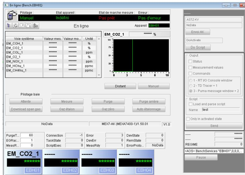
Figure 112. Interface de gestion de la communication et le contrôle de la baie d'analyse de gaz HORIBA sous PUMA
