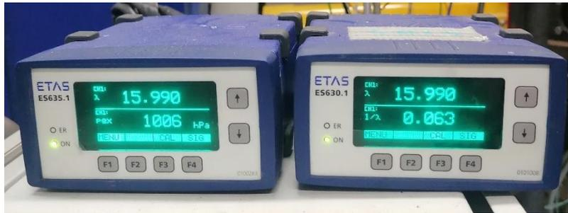
Figure 108. Photo des deux boîtiers ETAS ES635.1 et ES630.1 permettant la conversion des signaux lambda provenant des deux sondes placées en sortie turbine et en entrée échappement et dédiée à la mesure du banc.
