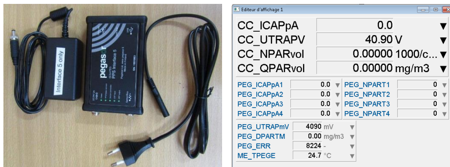
Figure 120. Éléments de visualisation des mesures de particules sous PUMA : a) à gauche, le boîtier de communication entre le PEGASOR et PUMA, b) à droite l'interface de visualisation des mesures du PEGASOR sous PUMA
