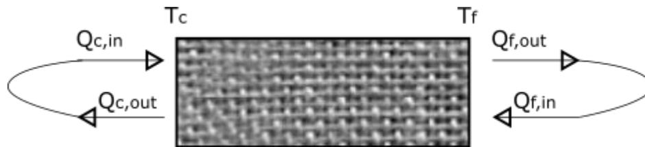
Figure 43 : Schéma de la chaleur entrante et sortante d'un régénérateur sur une période  $\tau$
