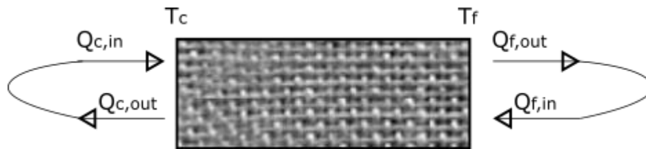
Figure 43 : Schéma de la chaleur entrante et sortante d'un régénérateur sur une période \tau
