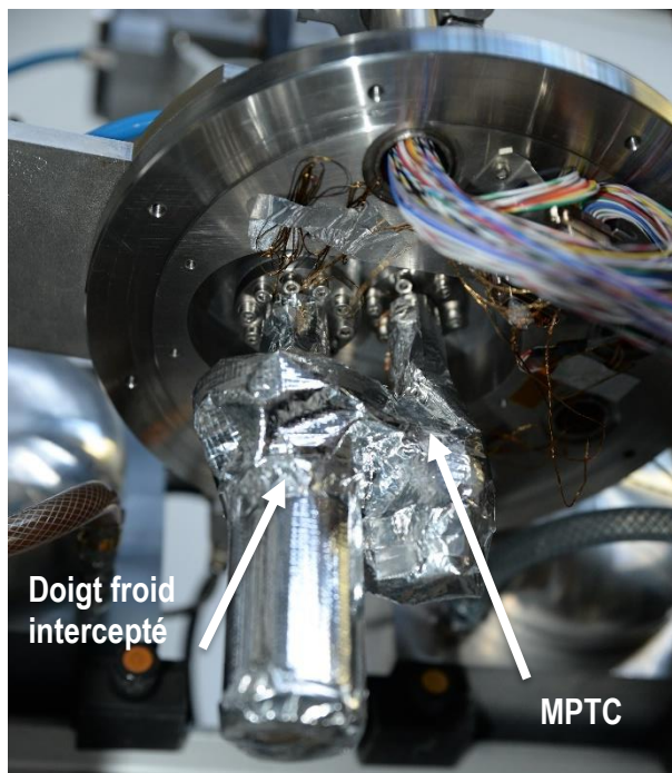
Figure 64 : Système en état de marche, la cuve est ouverte et les pulse tubes sont sous MLI pour les protéger du rayonnement
