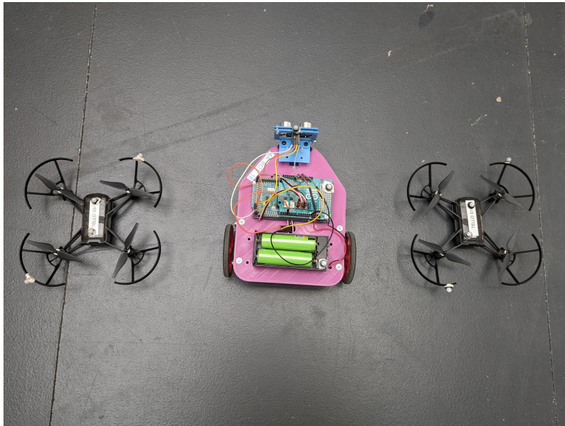
FIGURE 6.7 Photo de deux drones et d'une cible avec des marqueurs réfléchifs (boules grises).
