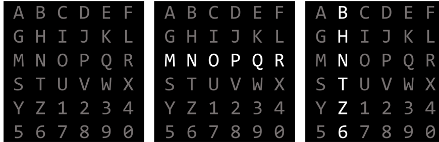
FIGURE 1.3 – Déroulement classique de l’utilisation d’un épeleur P300. Successivement chaque ligne puis chaque colonne est mise en surbrillance. Il est dit à l’utilisateur de se concentrer sur le flash lumineux lié à la ligne ou colonne où se situe la lettre qu’il souhaite écrire afin de déclencher un potentiel évoqué 300 ms après le flash. La ligne et la colonne sont ensuite déterminées afin de trouver la lettre choisie et de l’écrire
