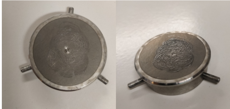
FIGURE 2.19 – Effet du laser sur la surface des cibles
