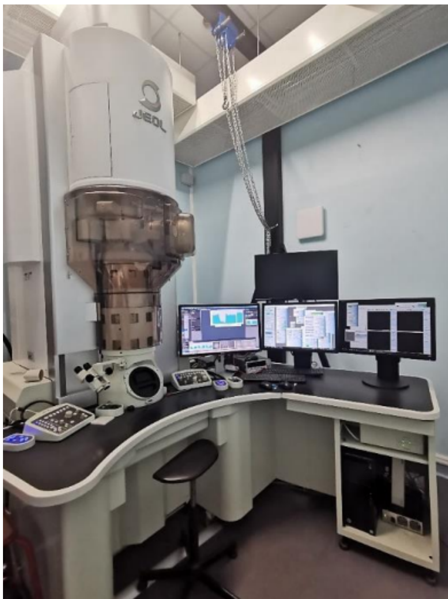
FIGURE 2.4 – Super-TEM ARMF200 JEOL présent au laboratoire MPQ.
