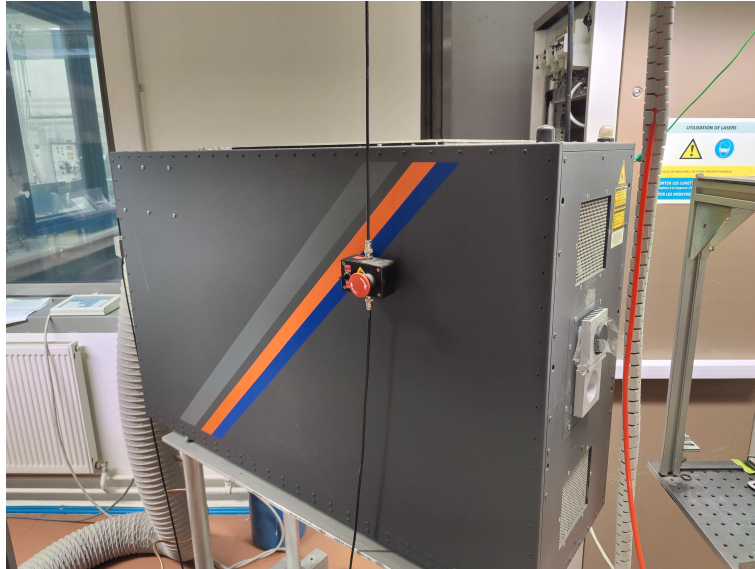
FIGURE 2.21 – Laser eximer COMpex pro 102F utilisé pour la croissance des nanomatériaux.
