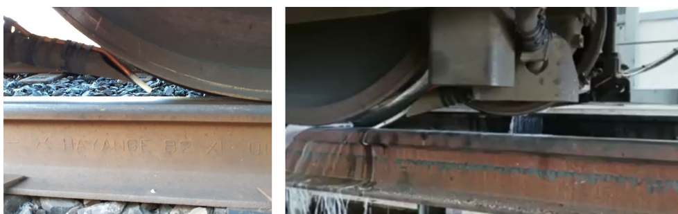
FIGURE 4.6 – Dispositif d'arrosage installé sur le premier essieu de la locomotive.
