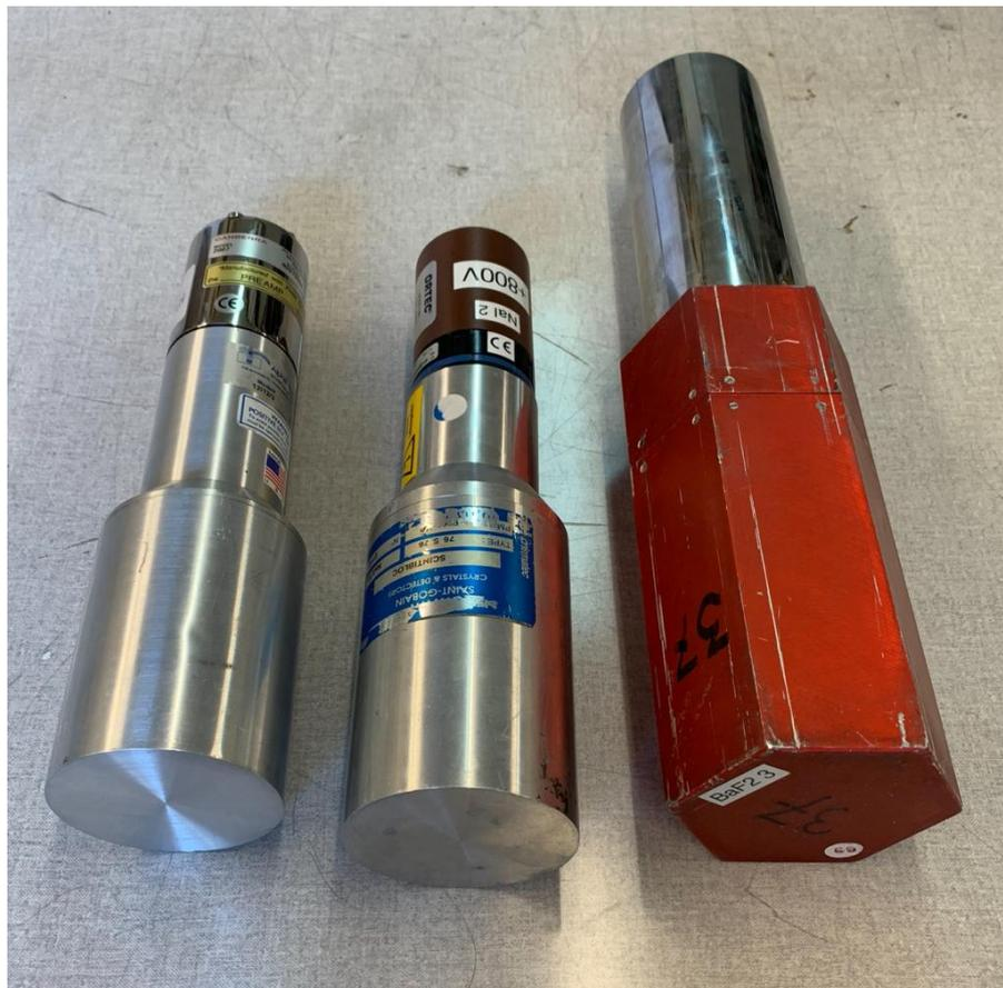
FIGURE 6.1 – À gauche : NaI(Tl) provenant de l'entreprise « Alpha Spectra Inc », au centre : NaI(Tl) provenant de l'entreprise « SAINT-GOBAIN », et à droite : BaF<sub>2</sub>.
