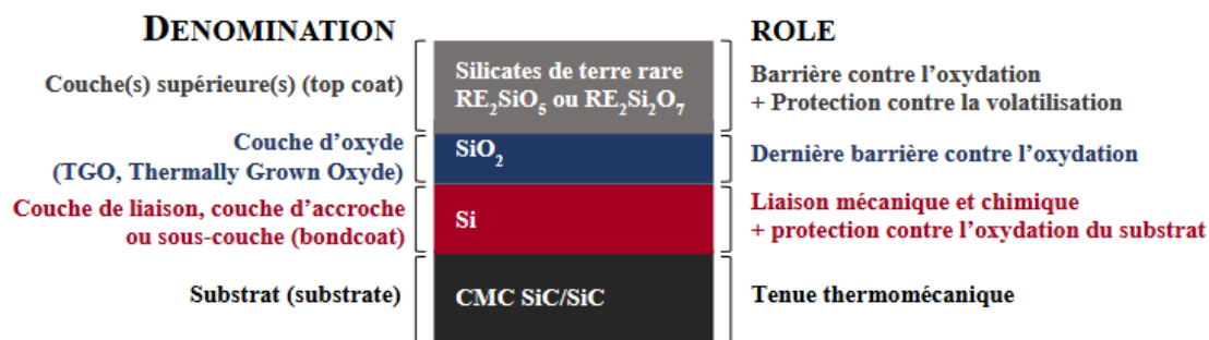
Figure 1.4 – Système multicouche avec EBC, dénomination et rôle de chaque couche [26].
