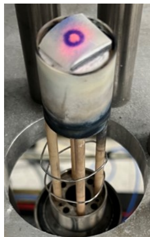
Figure 2.10 – Exemple de positionnement du faisceau laser.
