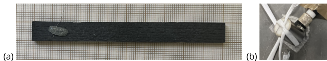
Figure 2.20 – Pour l'EA : (a) couplage du fil de platine avec la face arrière du système (face CMC), (b) couplage du fil de platine avec le capteur d'émission acoustique.
