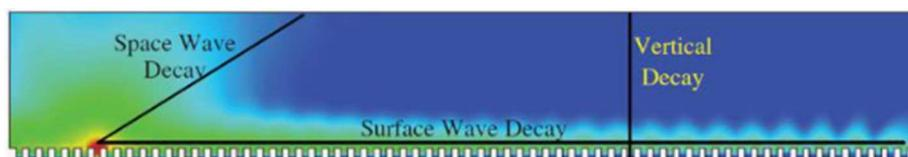
**Figure 12** : Décroissance de la propagation des ondes de surface Zenneck [36].
