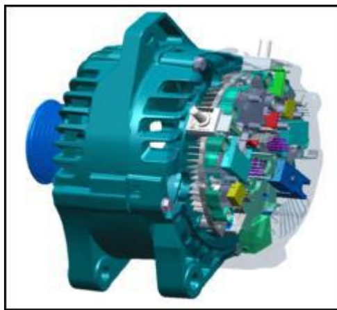
Figure 2 : Intégration multidomaine : l'alternateur i-Stars (Valeo®)
