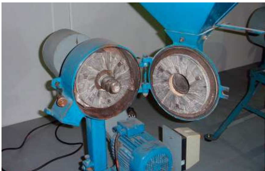
Figure 8 : Moulin à meules verticales
