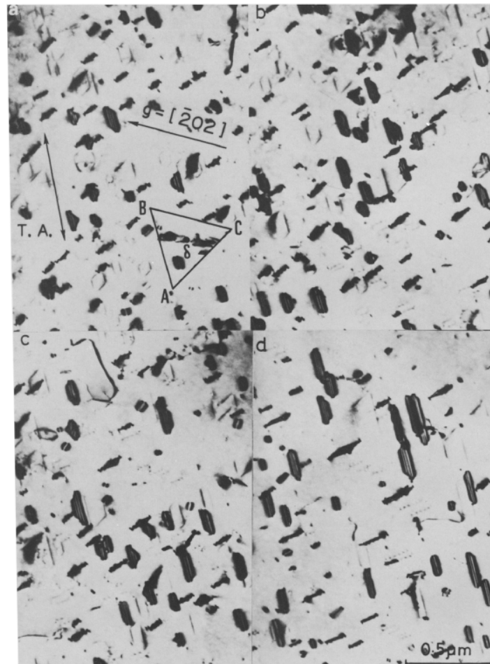
Figure 1.30 – Boucles de Frank interstitielles dans des lames en argent irradiées aux électrons de 1 MeV, avec un flux de 2,8 \times 10^{19} \text{ cm}^{-2} \cdot \text{s}^{-1} , à 130^\circ\text{C} , pendant 10 minutes. La direction de traction est indiquée par T.A. Chaque image correspond à une contrainte, de gauche à droite et de haut en bas : 0 MPa, 31,4 MPa, 48,1 MPa et 53,9 MPa [68, 69].
