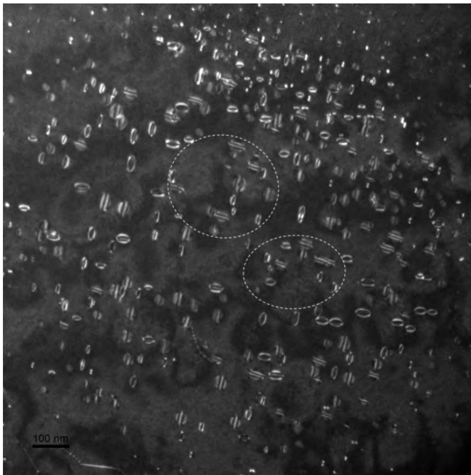
Figure 3.34 – Microstructure à la fin de la deuxième étape d'irradiation dans l'échantillon 2 : sous contrainte.
