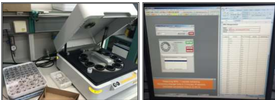
Figure 16 : Spectromètre de fluorescence X dispersif X de compteur Panalytical Epsilon 3 (l'Université de Brême, 2017).
