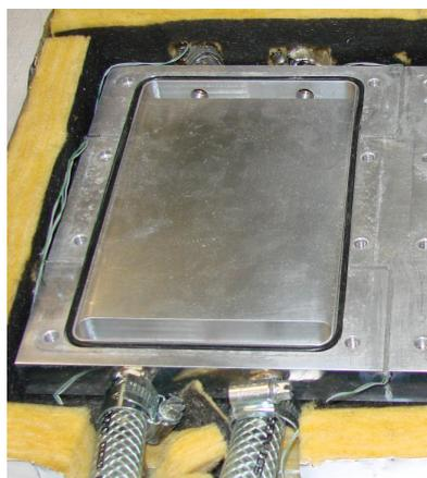
Fig 16. Semelle usinée pour essais à froid
