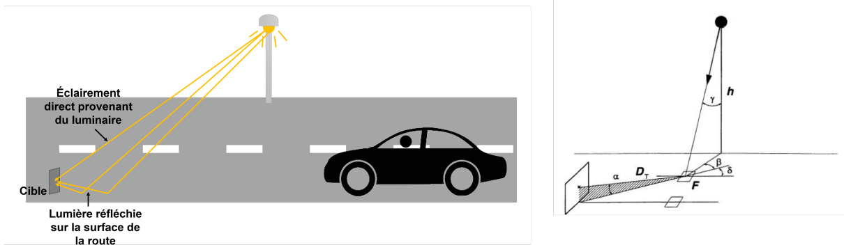
FIGURE 3.9 – A gauche : Sources de la luminance de la cible. A droite : Géométrie pour le calcul de l'éclairage cible indirect ( Source : Manuscrit de thèse de Gibbons (1998) ).
