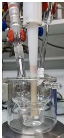
Figure 4-30 : Grande cellule électrochimique : à gauche électrode de référence ECS séparée par un pont salin, au milieu électrode tournante en carbone vitreux de 3 mm de diamètre, à droite contre-électrode en platine séparée par un pont salin.
