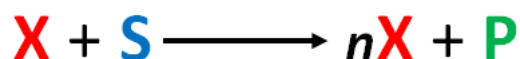
Figure 1-4 : Principe d'une réaction autocatalytique où un composé X catalyse sa propre formation en réagissant avec un substrat S.
