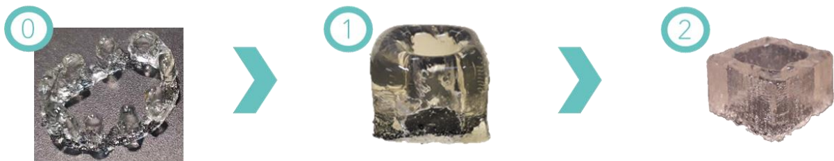
Figure 1.42. Evolution de la qualité d'impression de gels de gélatine en fonction des développements techniques améliorant la phase de refroidissement lors de l'impression : 0 – sans refroidissement ; 1 – refroidissement uniquement par le plateau d'impression ; 2 – couplage du refroidissement par le plateau et par le jet d'air comprimé.
