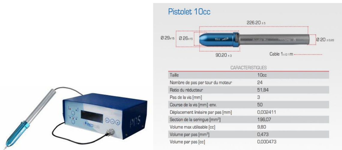
Figure 1.13. Le système Precifluid®. A – Vue extérieure et, B – Principales caractéristiques du système Precifluid® utilisé pour déposer le matériau alimentaire sur le plateau d'impression du second prototype d'imprimante développé au laboratoire.
