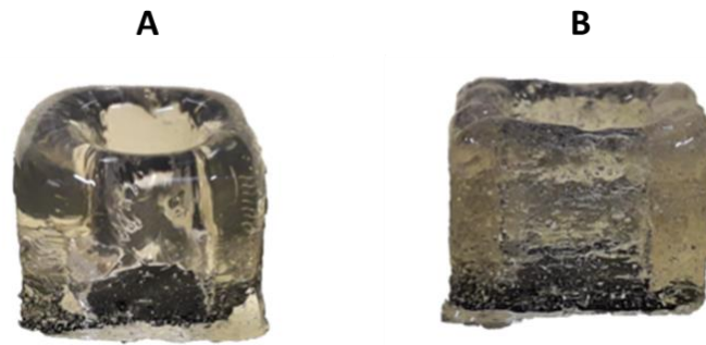
Figure 1.39. Images des gels de gélatine imprimés et refroidis : A – seulement, par le plateau d'impression ; et B - en associant avec un jet d'air comprimé à 0,4 MPa.
