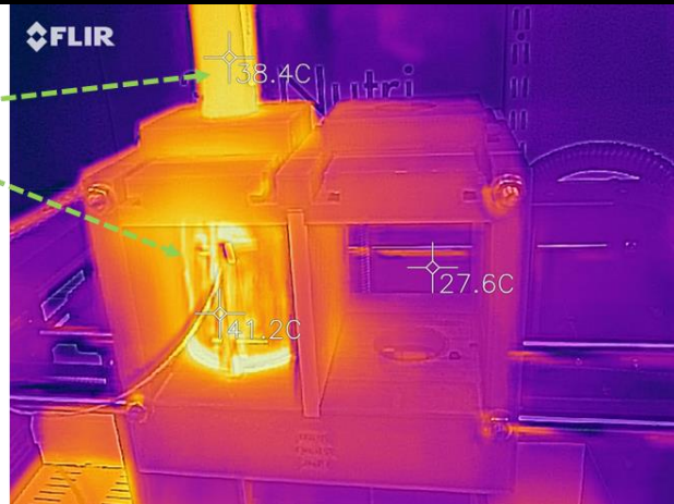
Figure 1.29. Visualisation, par imagerie infrarouge, du transfert de chaleur qui a lieu entre le collier chauffant et le doseur volumétrique Precifluid®.
