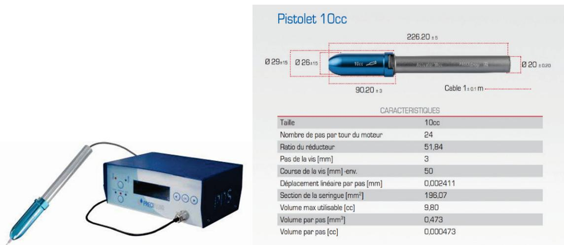
**Figure 1.13.** Le système Precifluid®. A – Vue extérieure et, B – Principales caractéristiques du système Precifluid® utilisé pour déposer le matériau alimentaire sur le plateau d'impression du second prototype d'imprimante développé au laboratoire.
