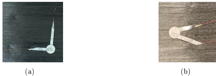
FIGURE 3.7 – Disposition des fils de connexion des PZT intégré de 10 \text{ mm} de diamètre : (a) dans les plaques de 150 \times 150 \text{ mm}^2 et (b) dans les plaques de 400 \times 400 \text{ mm}^2
