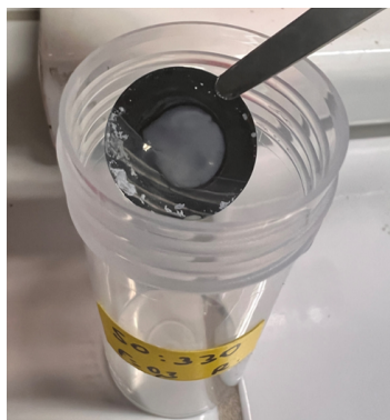
Figure 5.4 : Photo illustrant la redispersion d'un dépôt de \text{SiO}_2 avant séchage. De l'eau ultrapure est versée sur le dépôt encore humide et la suspension résultante est analysée par DLS.
