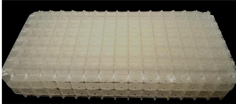
FIGURE 5.9 – Échantillon utilisant la géométrie cubique réalisé pour l'absorption en paroi de conduit
