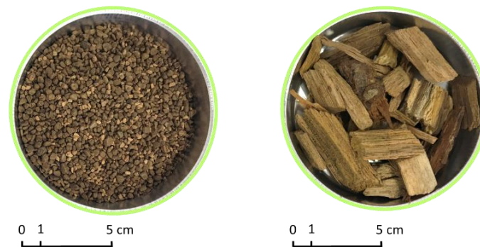
Figure 23 : Photos des noyaux d'olives (gauche) et des plaquettes de chêne brutes C22 (droite)
