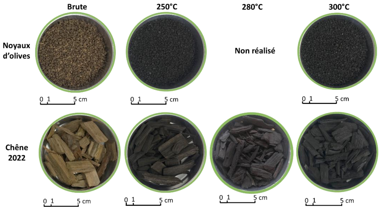
Figure 63 : Photos des noyaux d'olives et des plaquettes de chêne bruts et torréfiés
