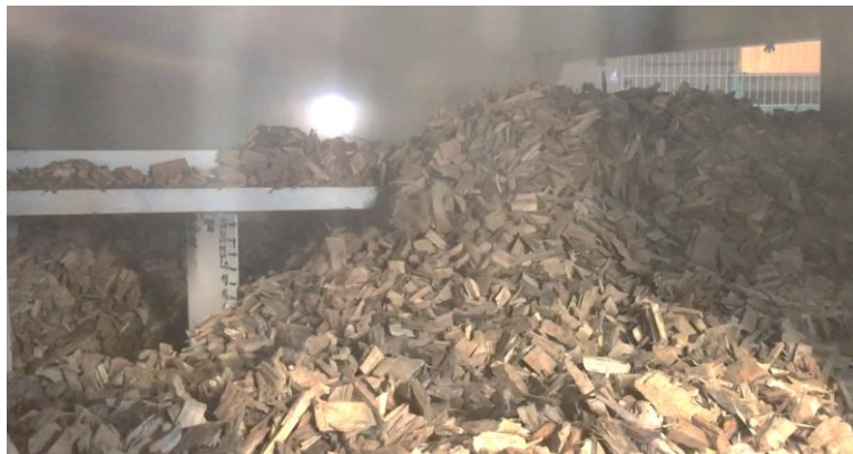
Figure 32 : Accumulation de biomasse sur un des bras de la sole ( \dot{m}_b = 1200 \text{ kg/h} , V_{arbre} = 1 \text{ tr/min} , Nb_{dents} + )
