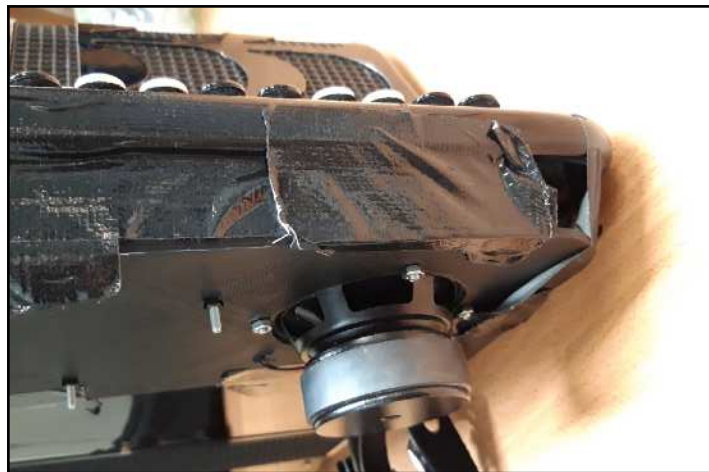
Figure 019 : positions des haut-parleurs dans l'accordéon hybride
