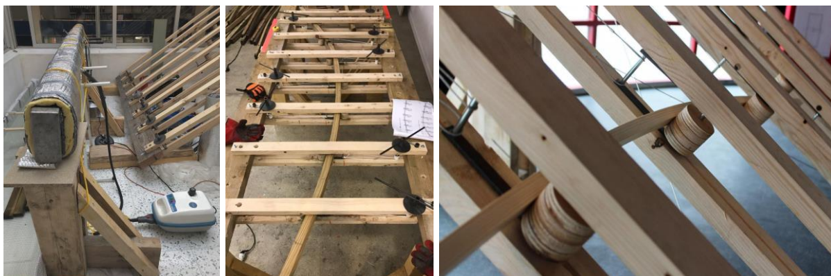
Figure 13 – L'étuve (à gauche) et la cintreuse (au centre et à droite) imaginées pour la réalisation de La Vrillette.
