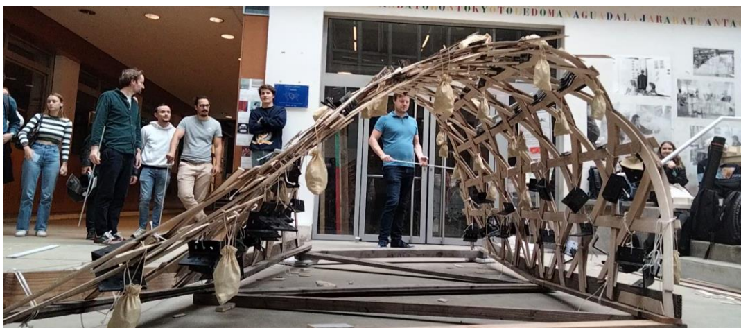
Figure 78 – Essai de chargement d'une maquette à l'échelle 1/2 d'un gridshell élastique [ENSA-PLV – CTA EE1].
