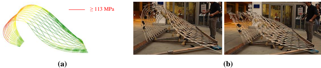
Figure 91 – Lors de nos simulations, une concentration de contrainte (95 – 105 MPa) est observée dans la zone de courbure maximale (a). À 65 kg, la valeur de la contrainte est supérieure à la limite de rupture du bois et la ruine de la maquette a lieu avant l'instabilité montrée par la simulation numérique (b).
