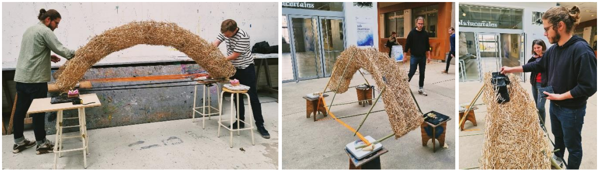
Figure 154 – Essais de chargements sur modèle réduit à échelle 1/5 ème avant et après l’ajout d’anti-dévers.
