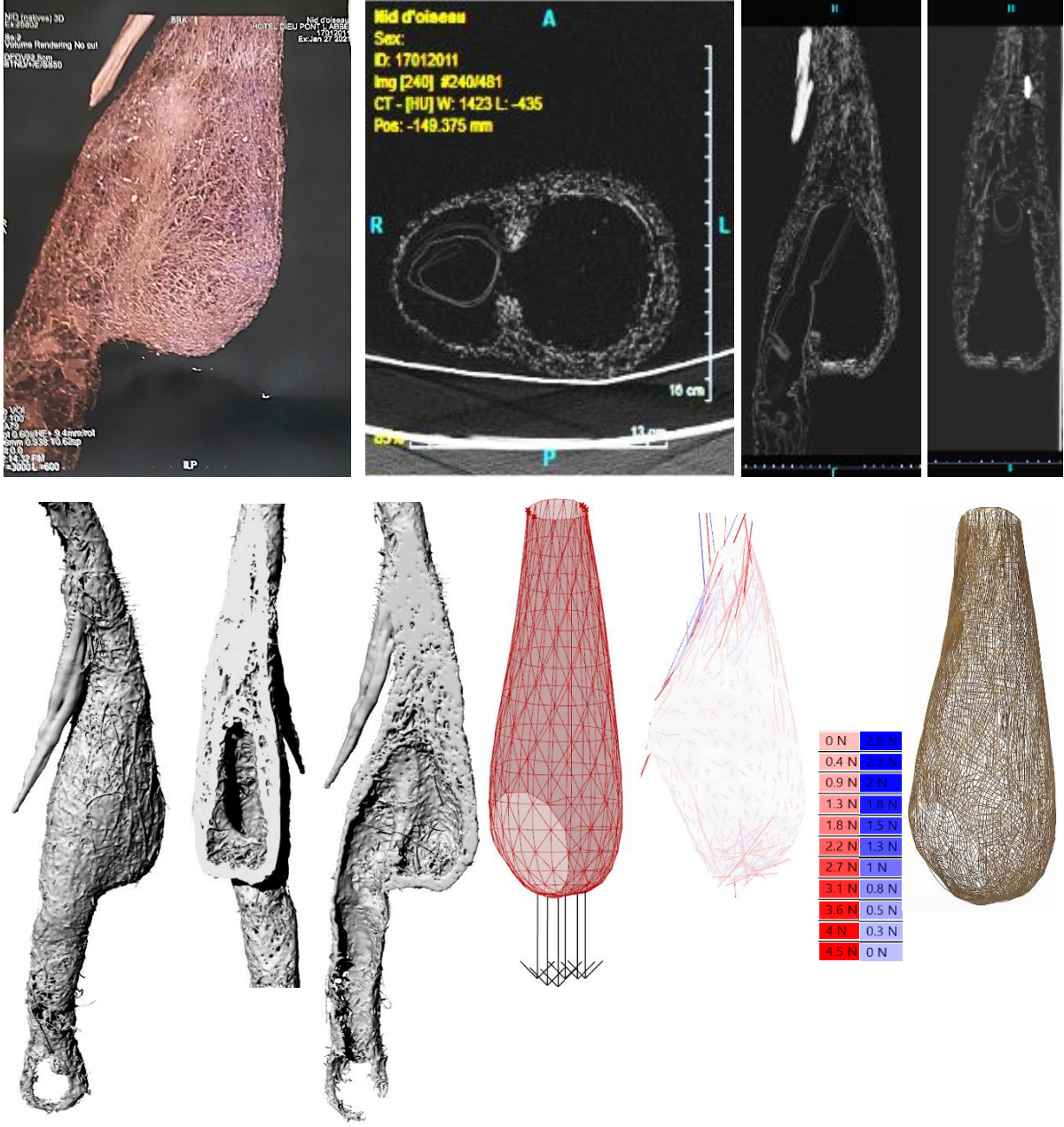
Figure 140 – Coupes du scanner RX et modèle 3D reconstruit comparés avec les prévisions de l'algorithme BAYA.
