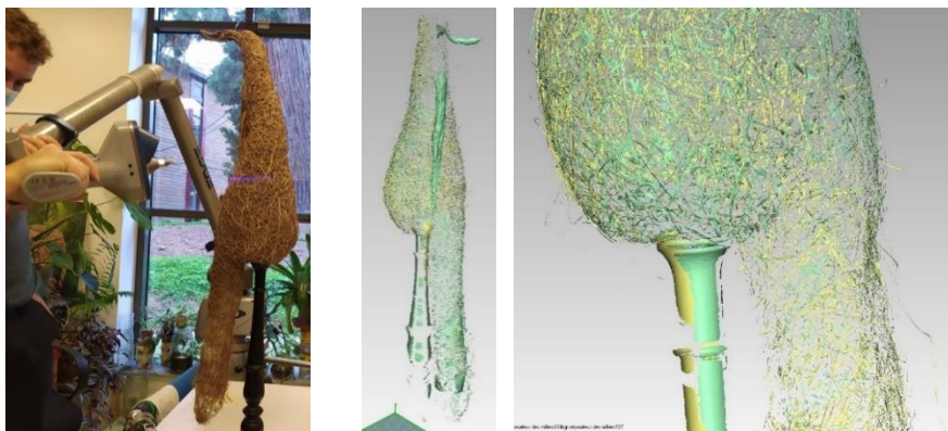
Figure 138 – Modélisation du nid par scanner surfacique laser [Pauvarel L., Bardy V. – CTA EE1].
