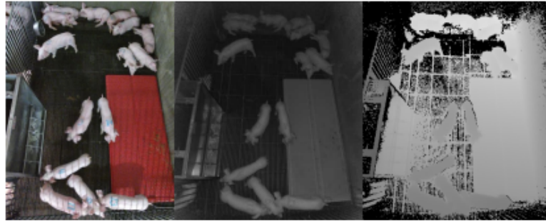
FIGURE 2.12 – Images couleur, infrarouge et de profondeur capturées par la caméra Kinect v2 dans [9]
