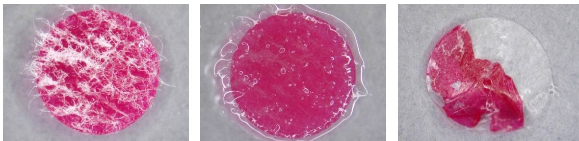
Figure 160 : Exemple du Rubine Red (aC+DEP+TPP+aV), de gauche à droite, avant immersion dans l'isopropanol, après 2 minutes d'immersion et après séchage.
