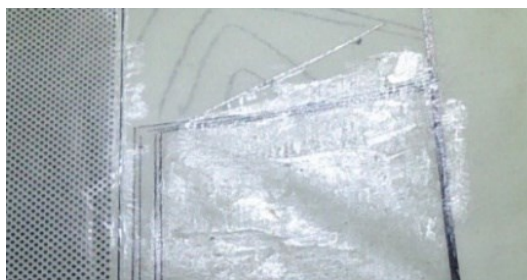
Figure 85 : Résidus d'adhésif souple sur le papier, AM 2007-2-415(0001).
