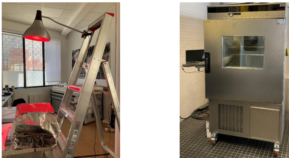
Figure 222 : Système de mise en œuvre pour combiner 45°C et 85% HR, à gauche, en atelier et à droite en laboratoire.
