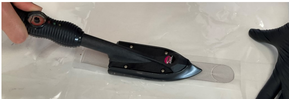
Figure 236 : Méthode d'application de chaleur à l'aide d'une spatule chauffante, du côté du zip.
