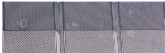
Figure 98 : Petites bulles d'air emprisonnées entre le zip et le papier de support, AM 2007-2-316.
