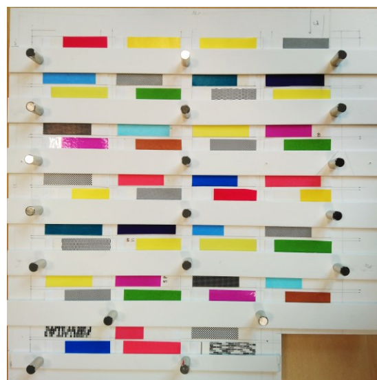
Figure 136 : Disposition des échantillons dans l'enceinte de vieillissement lumière.
