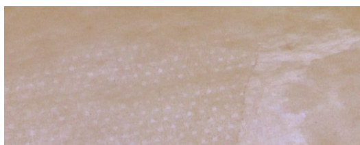
Figure 92 : Détail du motif du zip disparu dans la couche d'adhésif oxydée restée à la surface du papier, AM 2015-2-184.
