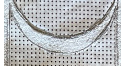
Figure 231 : Détail de l'éprouvette 11, le zip est encore aligné sur le cerne réalisé avant le deuxième vieillissement.
