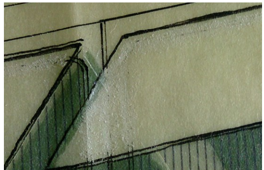
Figure 103 : Détail d'épidermages localisés, AM 2008-2-98.
