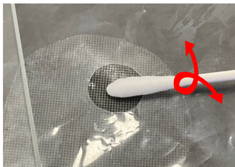
Figure 181 : Détails du coton tige posé sur la surface à dégager et indication du mouvement.
