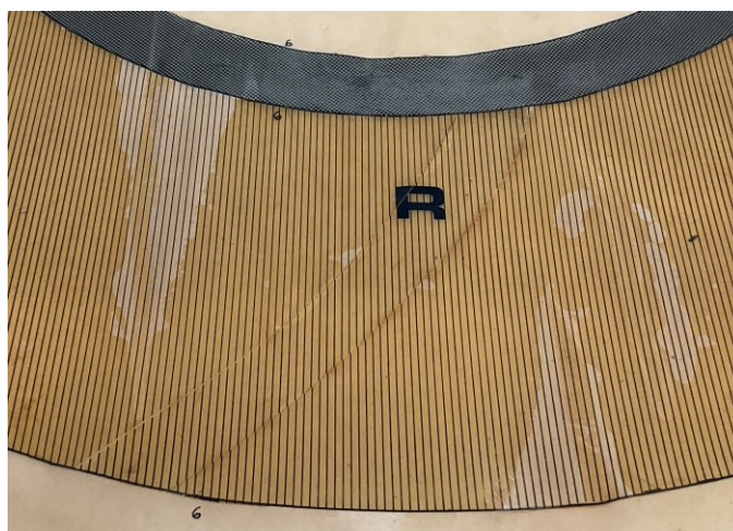
Figure 251 : Zones plus claires où le film est détaché de l'adhésif.
