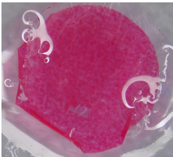
Figure 164 : Photographie sous loupe binoculaire pendant immersion de la référence aC+DEP+TPP+aV dans l'éthanol.
