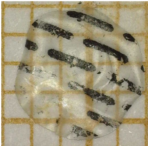
Figure 168 : Gondolement du zip aC+DEP+Cire après immersion dans l'alcool benzylique.
