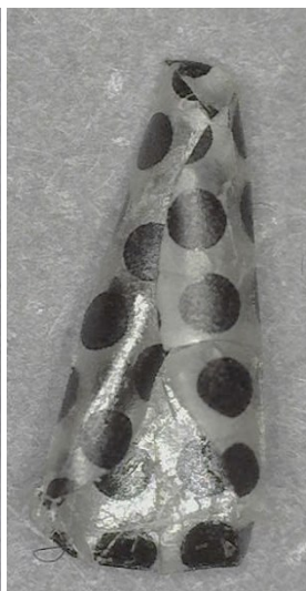
Figure 166 : Tuilage en cigarette pour le zip aC+DEP+aV après immersion dans l'isopropanol et séchage.
