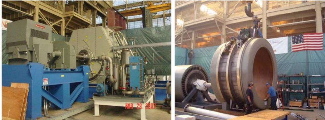
Figure I.24 – Le moteur supraconducteur HTC de 36.5 MW construit par AMSC [Gamble, 2010].
