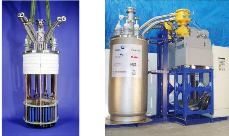
Figure I.20 – Limiteur de courant supraconducteur résistif 10 kV/ 10 MVA développé par Nexans Superconductors [Bock, 2005].
