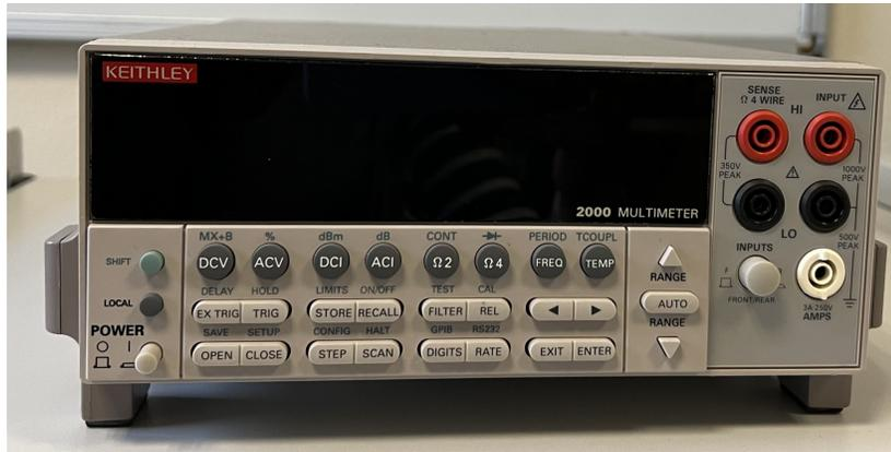
FIGURE A.2 – Nano-voltmètre « Keithley Model 2000 multimeter ».
