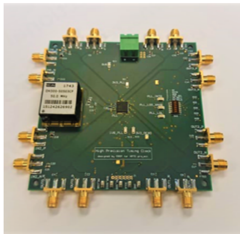
FIGURE 5.13 – Photographie de la carte HPTC fournie par le CERN, d'après [1]
