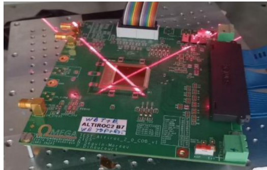
FIGURE 4.25 – Photographie d'ALTIROC2 en irradiation TID
