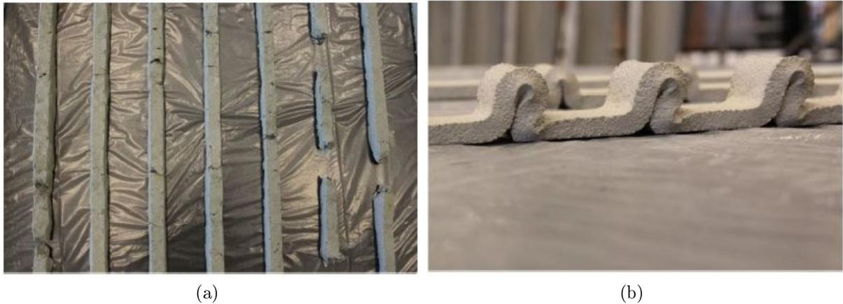
FIGURE 1.13 – Déchirure du filament (a) et instabilité du filament (b) [?].
