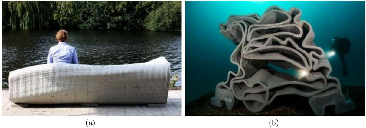
FIGURE 1.7 – Meubles urbains [?] (a) et structures de récifs artificiels [?] (b), construits par impression 3D en béton.
