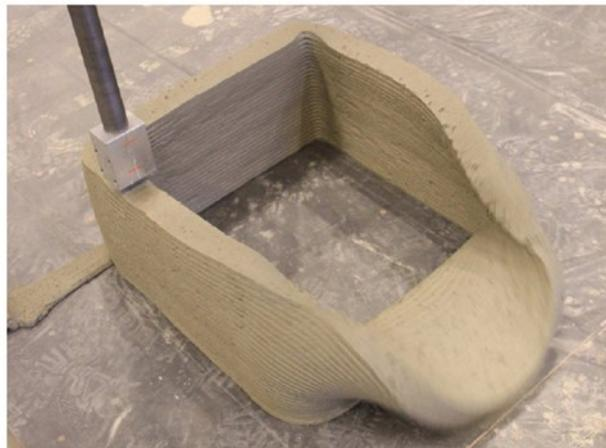
FIGURE 4.1 – Flambement local d'un mur carré au cours d'une impression 3D [?].
