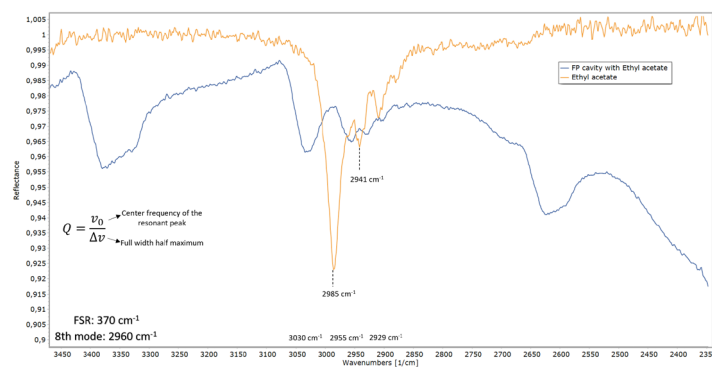
Figure 4. 16. Spectre infrarouge de la solution d'éthylacétate. En bleu, le spectre IR de la cavité \mu fluidique de FP dans laquelle la solution d'éthylacétate a été injectée.
