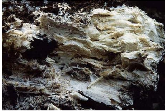
Figure 1. Apparence du bois attaqué par un champignon de pourriture blanche ( P. chrysosporium ) (Malviya, 2012).
