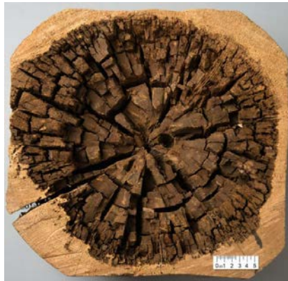
Figure 3. Apparence du bois attaqué par un champignon de pourriture brune (Goodell, 2020).
