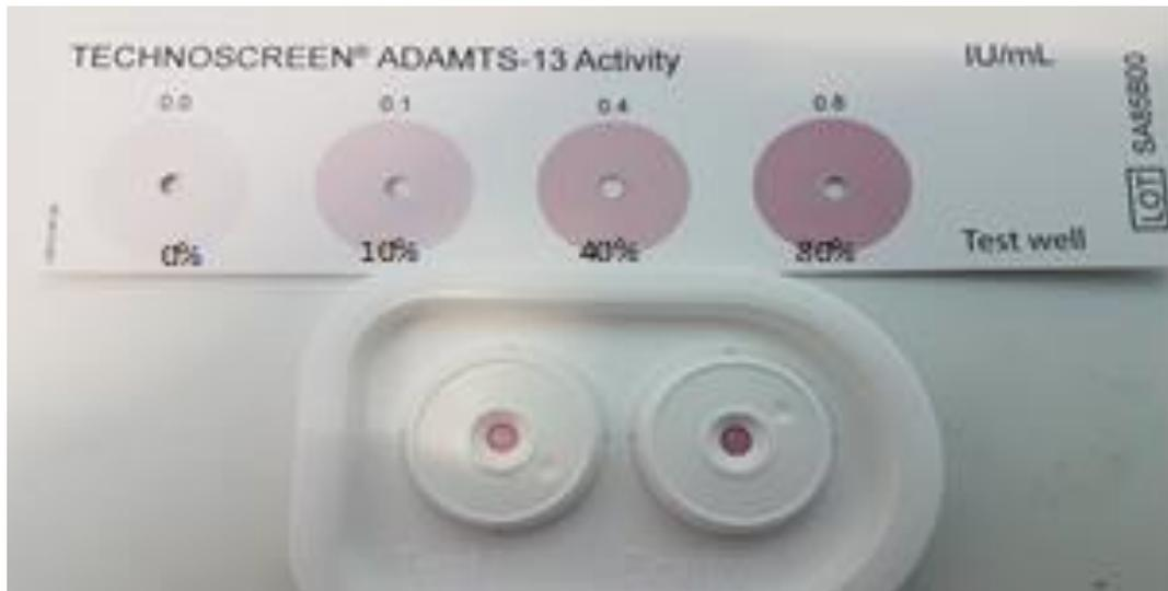
**Figure 23. Exemple de test rapide d'orientation diagnostique Technoscreen® ADAMTS13 activity.**
