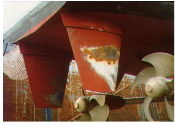
(b) Erosion sur un gouvernail due à la cavitation autour de l'hélice (extrait de Kim et al. [2])
