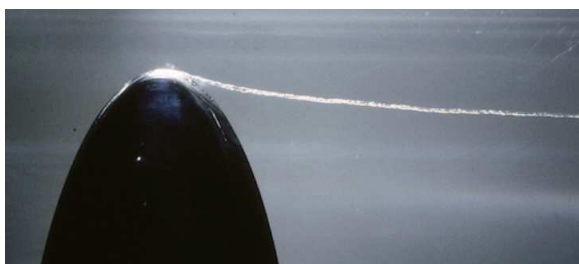
(a) Cavitation dans un tourbillon marginal
